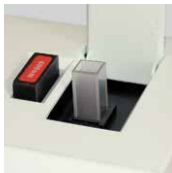
Измерение в квадратных кюветах и полумикрокюветах
